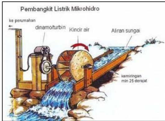
Gambar 2.43. Rangkaian pembangkit listrik mikrohidro ( http://images.google.co.id )
